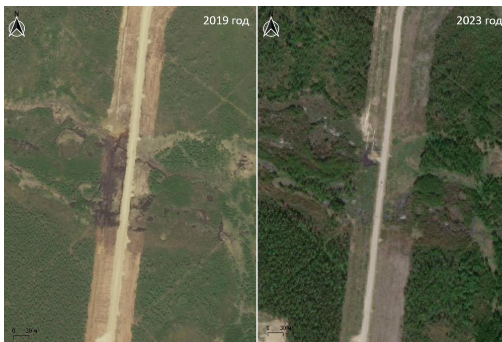
Рис. 1.2.4.1. Сравнение состояния придолинной мари мерзлотной, которую пересекает участок технологической дороги на спутниковых снимках за 2019 и 2023 гг. 59°58'19.3799"с.ш., 110°42'37.0465"в.д.
